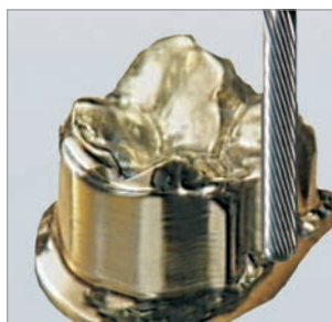
Fresaggio parallelo di una corona di metallo. Fresado paralelo de una corona metálica. Fresagem paralela de coroa metálica.
